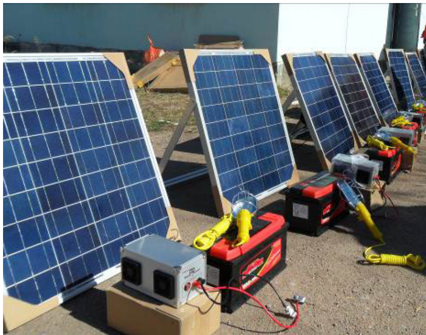
Рис. 28. Компактная фотоэлектрическая станция мощностью 100 Вт.
