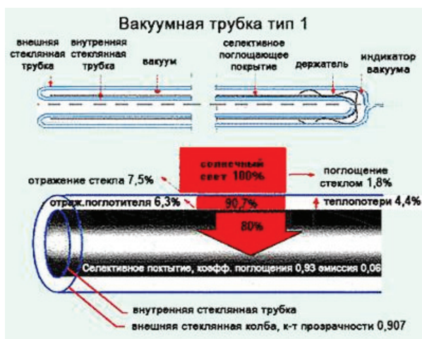
Рис. 4. Конструкция и схема распределения потерь в трубке коллектора.
