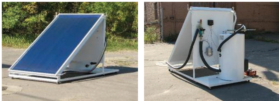
Рис. 13. Общий вид СВНУ с плоским коллектором 8
