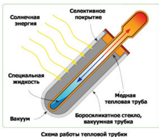
Рис. 8. Схема работы вакуумной трубки совместно с термосифонной.
