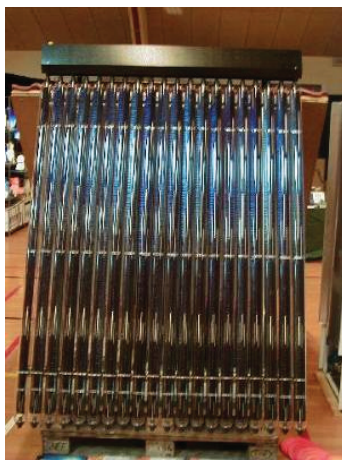
Рис. 10. Общий вид вакуумного коллектора с медными трубками.
