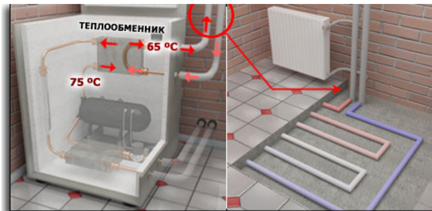
Рис.4. Схема работы системы отопления с теплым полом.
