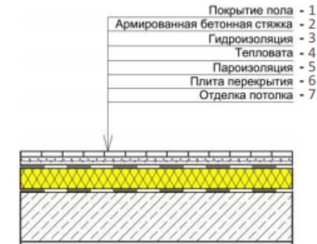
Теплоизоляция пола по бетонному перекрытию
