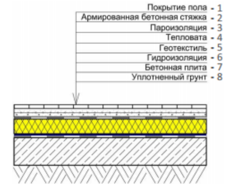
Теплоизоляция пола по грунту
