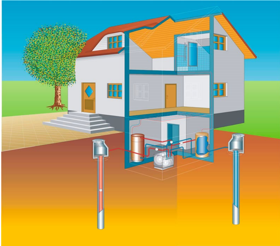
Тип 1. Геотермальный тепловой насос с открытым контуром
