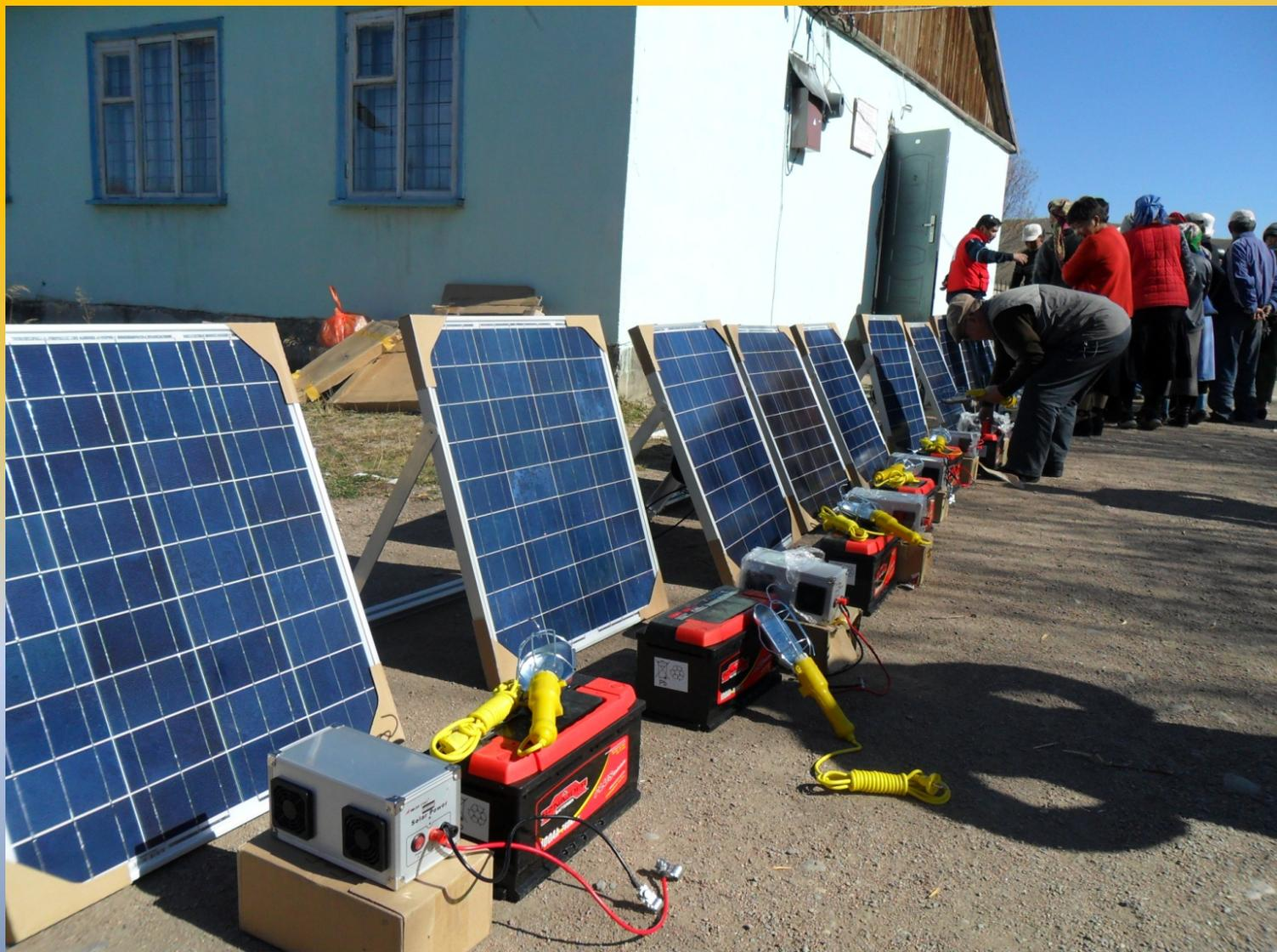
**Компактная фотоэлектрическая станция мощностью 100 Вт.**
