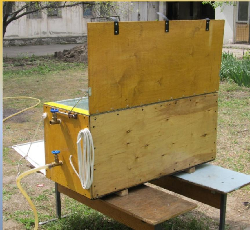
**Самодельный солнечный водонагреватель.** Предназначен для получения горячей воды в весенне-летне-осенний период года.
